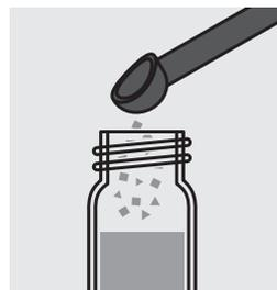
Agregar 1 cuchara micrométrica azul rasa de O<sub>3</sub>-2 y cerrar la cubeta con el tapón roscado.
