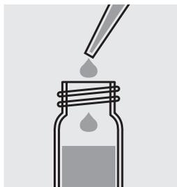
Llenar con una pipeta 2,0 ml de la muestra **cuidadosamente** en la cubeta, cerrar ésta con el tapón roscado y mezclar enérgicamente.
