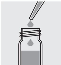
Agregar con una pipeta 2,0 ml de una solución 1,54 N de hidróxido de sodio, cerrar la cubeta con el tapón roscado y mezclar el contenido invirtiéndola con cuidado repetidas veces.
