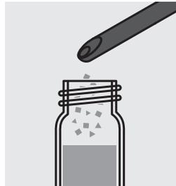
Agregar 1 cuchara micrométrica gris rasa de **Ph-1K** y cerrar la cubeta con el tapón roscado.
