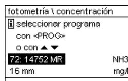
Cambiar al modo de medición *fotometría* y seleccionar el programa No. 72.
