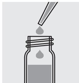
Añadir 1,0 ml de la muestra en una cubeta de reacción con una pipeta y cerrar la cubeta con el tapón roscado.
