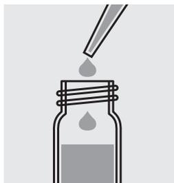
Llenar con una pipeta 0,50 ml **CI-1K** en una cubeta de reacción, cerrar con el tapón roscado y mezclar.
