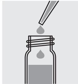
Agregar 2,0 ml **Si-2** con una pipeta y mezclar.
