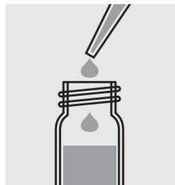
Agregar 2,0 ml de la muestra preparada en una cubeta de reacción **Total Nitrogen Acid LR Tube (Reagent C)** con una pipeta y cerrar la cubeta con el tapón roscado.
