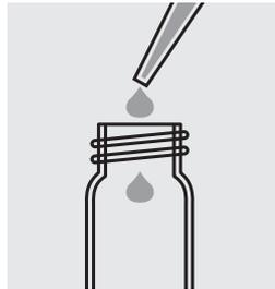
Agregar 8,0 ml de agua destilada con la pipeta en la cubeta vacía.
