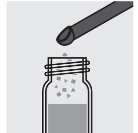
Agregar 1 cuchara micrométrica verde rasa de **Ph-2K** y cerrar la cubeta con el tapón roscado.
