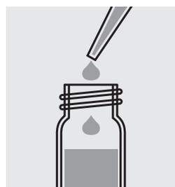
Añadir 2,0 ml **Sodium hydroxide 1.00 N** con una pipeta, cerrar la cubeta con el tapón roscado y mezclar.
