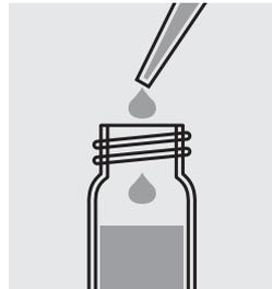
Agregar 0,20 ml **Cd-1K** con una pipeta y mezclar.
