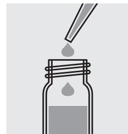
Agregar 2,0 ml de la muestra preparada en una cubeta de reacción **Total Nitrogen Acid HR Tube (Reagent C)** con la pipeta y cerrar la cubeta con el tapón roscado.
