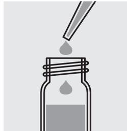
Agregar 1,5 ml de la muestra cuidadosamente con la pipeta, cerrar la cubeta con el tapón roscado y mezclar.
