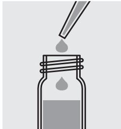
Añadir 0,50 ml de **AC-2** con la pipeta, cerrar con el tapón roscado y mezclar.
