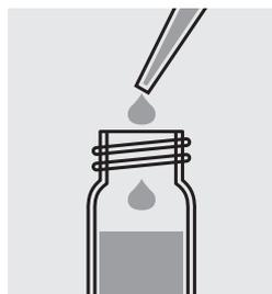
Añadir 0,50 ml de **AC-2** con la pipeta, cerrar con el tapón roscado y mezclar.
