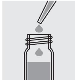
Agregar 0,50 ml de la muestra con una pipeta y mezclar.
