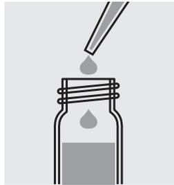
Agregar 0,5 ml de la muestra con la pipeta, cerrar la cubeta con el tapón roscado y mezclar enérgicamente durante 30 segundos, como mínimo. Probablemente no se disuelva completamente todo el material sólido, quedando un residuo.
