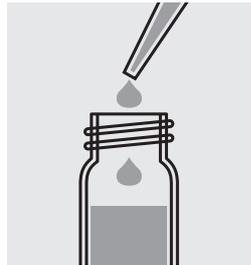
Agregar 10,0 ml de la muestra con una pipeta y mezclar.
