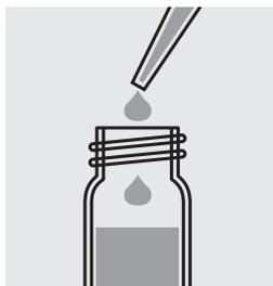
Agregar 5,0 ml **Ca-1** con una pipeta y mezclar.
