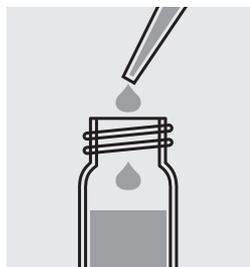
Llenar con una pipeta 0,1 ml de la muestra en una cubeta de reacción.
