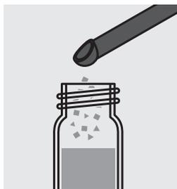
Agregar 1 ensayo de micrométrica verde rasa de **Ag-2** y cerrar la cubeta con el tapón roscado.
