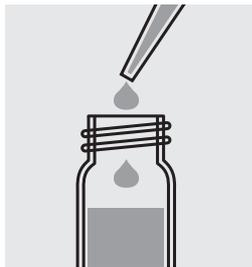
Llenar con una pipeta 0,5 ml de la muestra en una cubeta de reacción.
