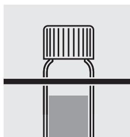
Volver a colocar la cubeta en el soporte y dejar en reposo, hasta que se haya enfriado a **temperatura ambiente**.
