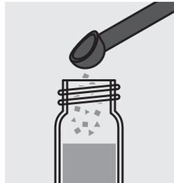
Agregar 1 cuchara micrométrica azul rasa de **CN-3K** y cerrar la cubeta con el tapón roscado.
