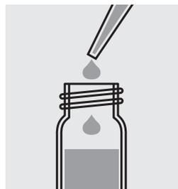
Añadir 8,0 ml de la muestra con la pipeta, cerrar la cubeta con el tapón roscado y mezclar.
