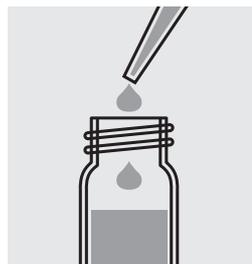
Agregar 2,4 ml **Al-2** con una pipeta y mezclar.
