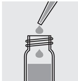
Añadir 0,50 ml de la muestra con la pipeta, cerrar con el tapón roscado y mezclar.
