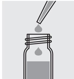
Agregar muy lentamente 1,5 ml de la muestra preparada con la pipeta, cerrar la cubeta con el tapón roscado y mezclar **enérgicamente**.
