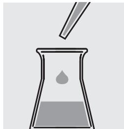
Agregar 1,0 ml de **As-6** con la pipeta a la solución en el matraz Erlenmeyer y mezclar.
