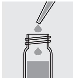
Agregar 1,0 ml **H-1K** con una pipeta, cerrar la cubeta con el tapón roscado y mezclar.
