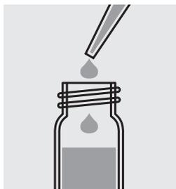
Agregar 2,0 ml de la muestra cuidadosamente con la pipeta, cerrar la cubeta con el tapón roscado y mezclar.
