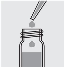
Pipetear 2,0 ml de la muestra en una cubeta de reacción provista de tapa roscada.
