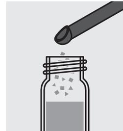
Agregar 1 cuchara micrométrica verde rasa de SO<sub>4</sub>-1K y cerrar la cubeta con el tapón roscado.
