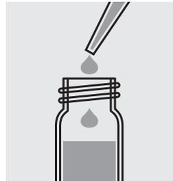
Llenar con una pipeta 1,0 ml de la muestra en una cubeta de reacción y mezclar.
