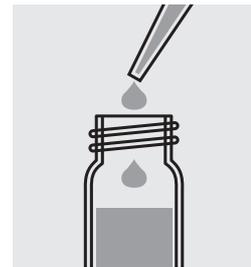
Añadir 2,0 ml de la **muestra preparada** con la pipeta, cerrar la cubeta con el tapón roscado y mezclar.
