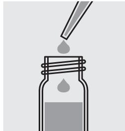
Llenar con una pipeta 5,0 ml de la muestra en una cubeta de reacción y mezclar.
