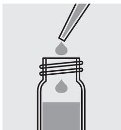
Llenar con una pipeta 0,50 ml de la muestra en una cubeta de reacción y mezclar.
