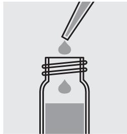
Añadir 1,0 ml de la muestra con la pipeta, cerrar con el tapón roscado y mezclar.
