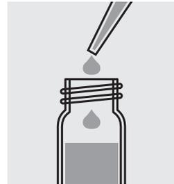
Agregar 0,20 ml **Cd-2** con una pipeta y mezclar.
