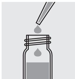
Agregar 1,20 ml NH<sub>4</sub>-1 con una pipeta y mezclar.
