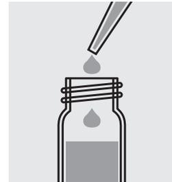
Agregar 0,50 ml de **PO4-1** con una pipeta y mezclar.
