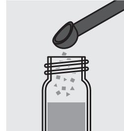
Agregar 1 cuchara micrométrica azul rasa de PO<sub>4</sub>-2 y cerrar la cubeta con el tapón roscado.
