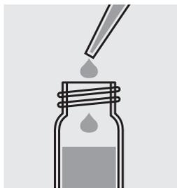
Llenar con una pipeta 0,1 ml de la muestra **cuidadosamente** en la cubeta, cerrar ésta con el tapón roscado y mezclar enérgicamente.
