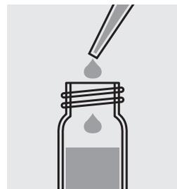
Añadir 2,0 ml **Sodium hydroxide 1.54 N** con una pipeta, cerrar la cubeta con el tapón roscado y mezclar.
