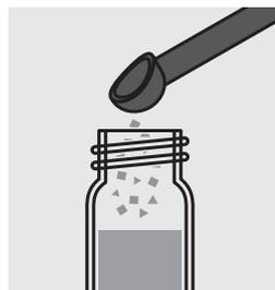
Agregar 1 cuchara micrométrica azul rasa de ClO<sub>2</sub>-2 y cerrar la cubeta con el tapón roscado.
