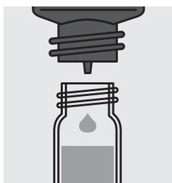
Agregar 2 gotas de **Ni-1** y mezclar. Cuando la solución pierde color, continuar agregando gota a gota **Ni-1**, hasta que la coloración ligeramente marrón permanezca invariable.
