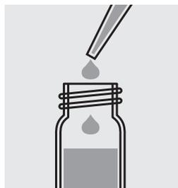
Llenar con una pipeta 7,0 ml de la muestra en una cubeta de reacción y mezclar.
