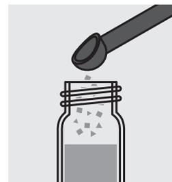
Agregar 1 cuchara micrométrica azul rasa de **SO<sub>4</sub>-2** y cerrar la cubeta con el tapón roscado.
