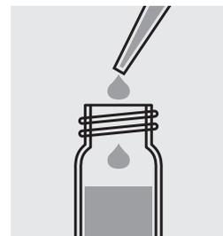
Añadir 5,0 ml de la muestra con la pipeta, cerrar con el tapón roscado y mezclar.
