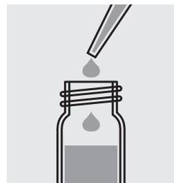
Agregar 0,50 ml **Al-3** con una pipeta, cerrar la cubeta con el tapón roscado y mezclar.
