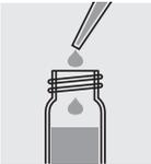
Llenar con una pipeta 3,0 ml de la muestra **cuidadosamente** en la cubeta, cerrar ésta con el tapón roscado y mezclar
