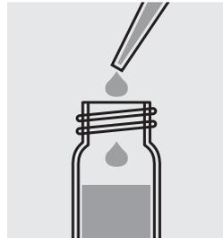
Agregar 10,0 ml **Ca-1** con una pipeta y mezclar.
