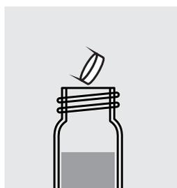
Añadir 1 comprimido de **ALKA-M-PHOTOMETER** directamente de la lámina, aplastar con la barra agitadora y cerrar con la tapa roscada.
