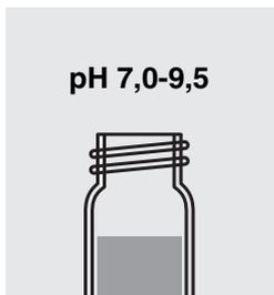
Verificar el valor pH. Rango nominal: pH 7,0-9,5. En caso necesario, corregir con lejía de sosa diluída o con ácido sulfúrico diluido.
