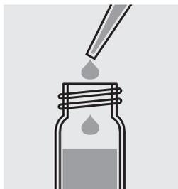
Añadir 1,0 ml de la muestra con la pipeta, cerrar la cubeta con el tapón roscado y mezclar.
